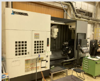
オークマ 複合旋盤 MULTUS U3000 加工範囲 (mm) \phi 320 \times 1500
