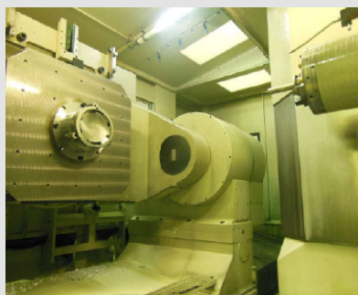
三井精機 HU100-5X 加工範囲 (mm) 1300 \times 1200 \times 1200
