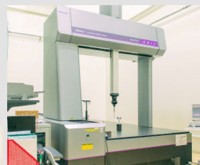
ミットヨ CNC3 次元測定機 APEX163015 測定範囲 (mm) 1600 \times 3000 \times 1500
