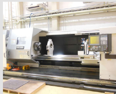
オークマ CNC 旋盤 加工範囲 (mm) \phi 600 \times 4000
