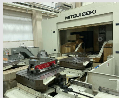
三井精機 HU63-5X (6 パレ) 加工範囲 (mm) 800 \times 800 \times 900
