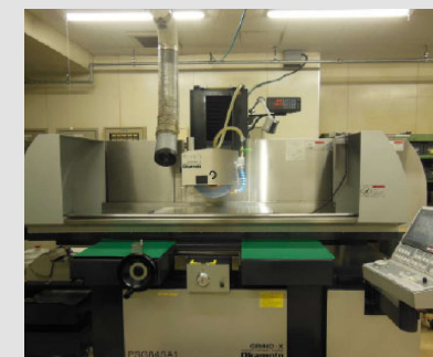
岡本工作機械 平面研削盤 PSG-84SA1 加工範囲 (mm) 800 \times 400 \times 500
