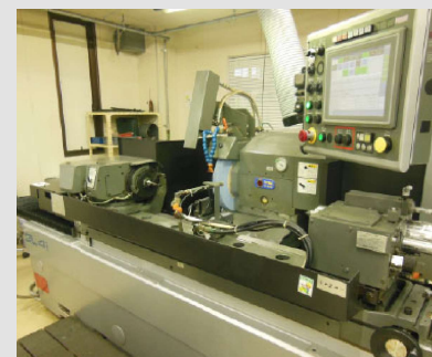
ジェイテクト 円筒研削盤 GL4Ti-100 加工範囲 (mm) \phi 300 \times 1000
