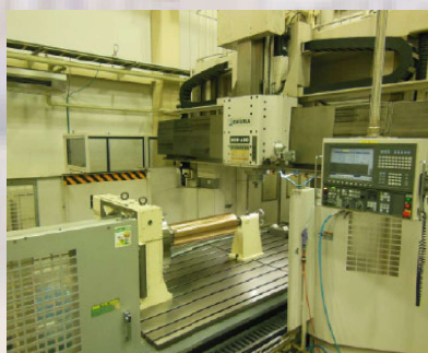
オークマ 5面加工機 MCR-A5C 加工範囲 (mm) 4000 \times 2000 \times 1500 \phi 800 円テーブル 同時4軸加工が可能
