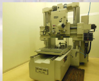
三井精機 ジグ中ぐり盤 J6BD3 加工範囲 (mm) 1000 \times 750 \times 800 2021年にレトロフィット
