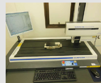
東京精密 高精度輪郭形状測定機 2900DX3-23 測定範囲 (mm) Z=500 L=200
